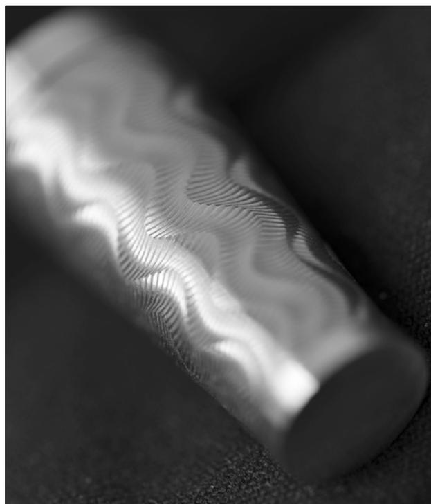
Fig. 2: Exemple de guillochage en 3D.
