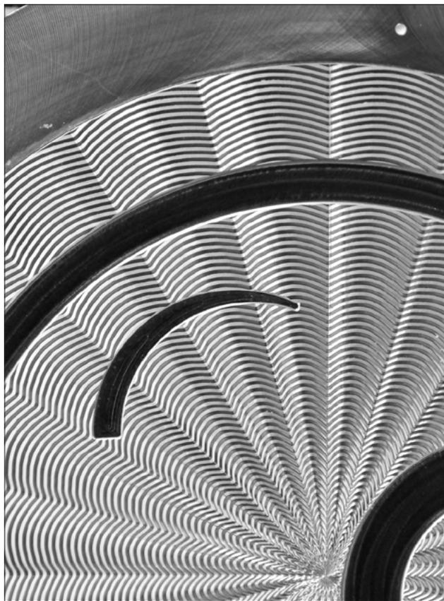
Fig. 1: Exemple de couplage d'usinage conventionnel et guillochage.
