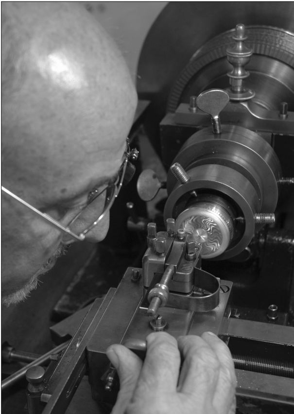
Guillocheur sur sa machine et travail du burin
